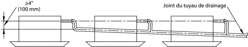
La spécification du joint du tuyau de drainage doit être compatible avec la capacité de fonctionnement de l'unité.
